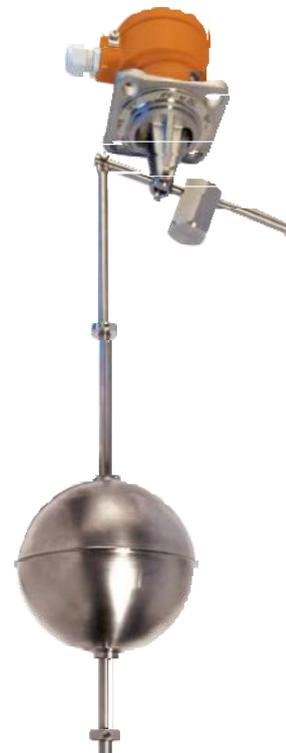
Гистерезис может регулироваться путем размещения колец на стержне. Размещение противовеса может компенсировать различные длины стержней.
